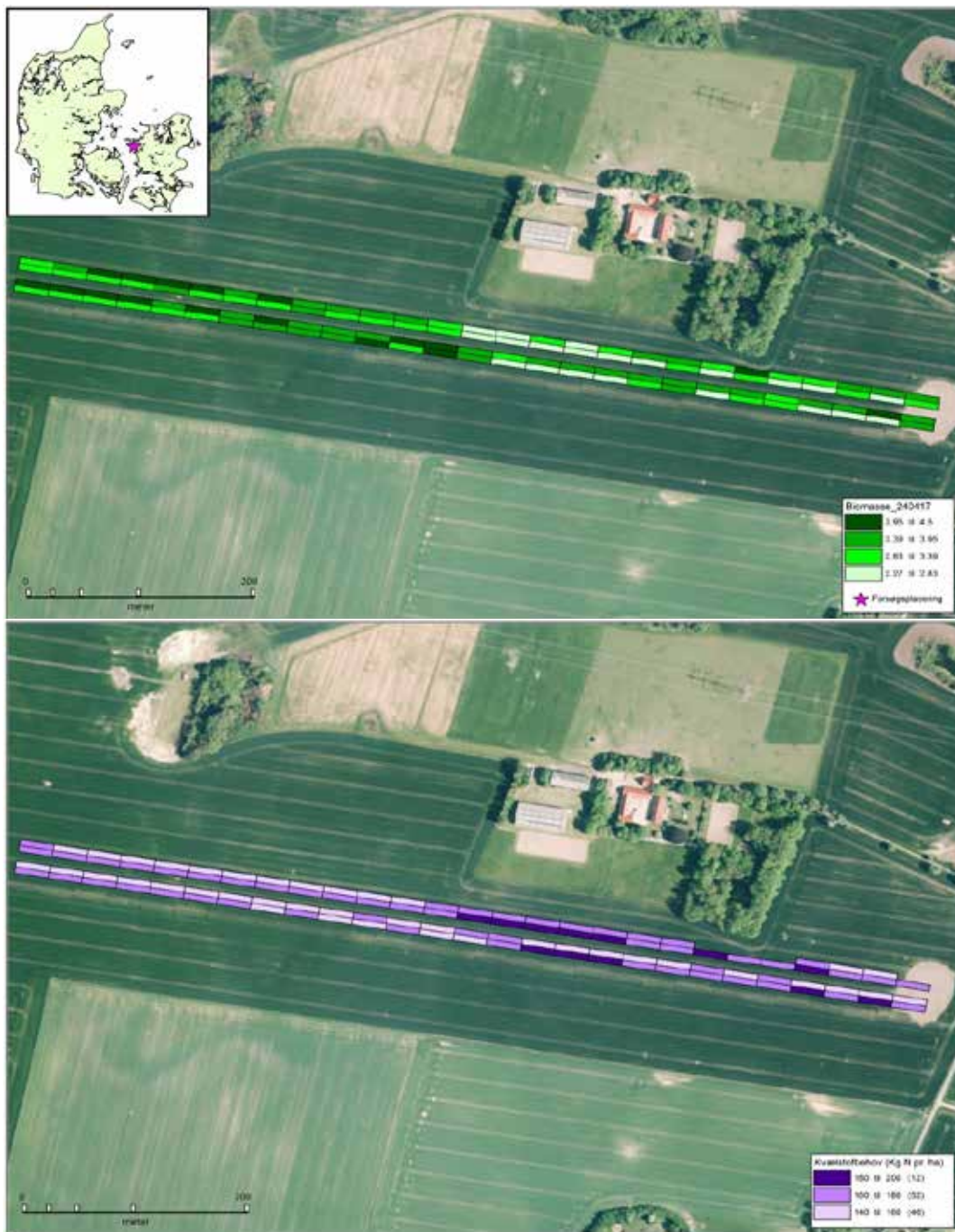
FIGUR 13. Øverst et kort over biomassen målt i parcellerne i forsøget i Kalundborg med Yara N-sensor før anden gødskning midt i april, hvor hele forsøgsarealet er tildelt samme kvælstofmængde. Nederst et kort over kvælstofbehovet beregnet ud fra biomassemålingerne. Mellem parcellerne varierer behovet mellem 140 og 190 kg kvælstof pr. ha.
